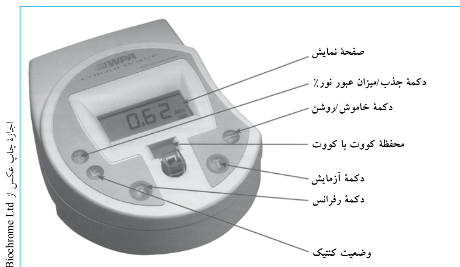
شکل ۶۳. کنترل‌های یک رنگ‌سنج قابل حمل
